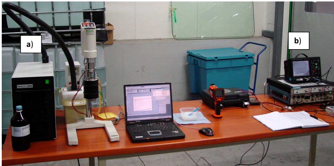
Rys. B1. Stanowisko pomiarowe wykorzystywane do testów w warunkach przemysłowych (pomiar lepkości – (a) oraz pomiary ultradźwiękowe - (b)).
