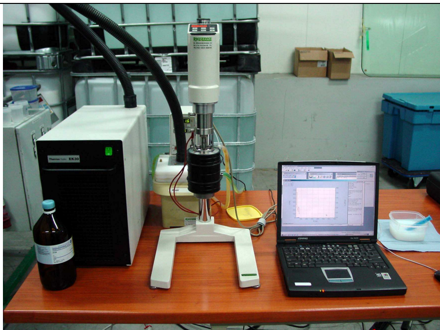
Rys. B4. Stanowisko pomiarowe wykorzystywane w pomiarach lepkości zolo-żeli.
