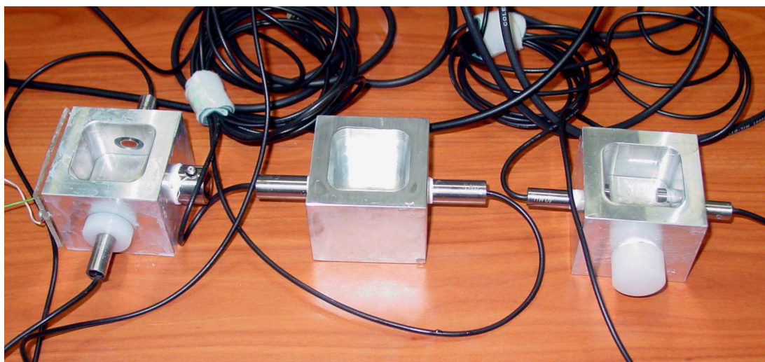
Rys. B2. Widok komór pomiarowych wykorzystywanych w badaniach ultradźwiękowych zolo-żeli.
